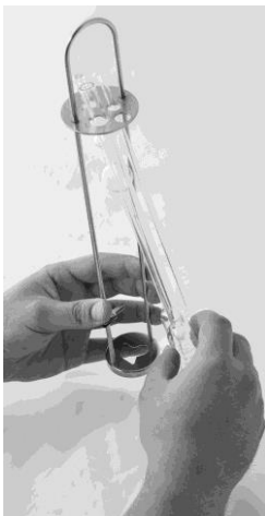
Abb. 5 Einführen bzw. Austauschen eines Viskosimeters mit Lichtschrankenabtastung
