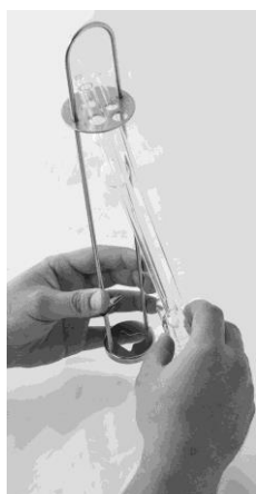
Fig. 5 Introduction ou remplacement d'un viscosimètre avec détection à barrières lumineuses dans un support de fixation
